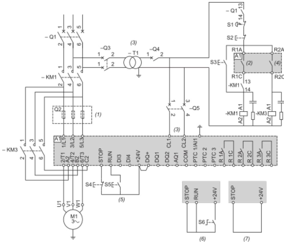
(1) : Installation de fusibles à action rapide supplémentaires pour passer à la coordination de type 2 conformément à la norme IEC 60947-4-2.
