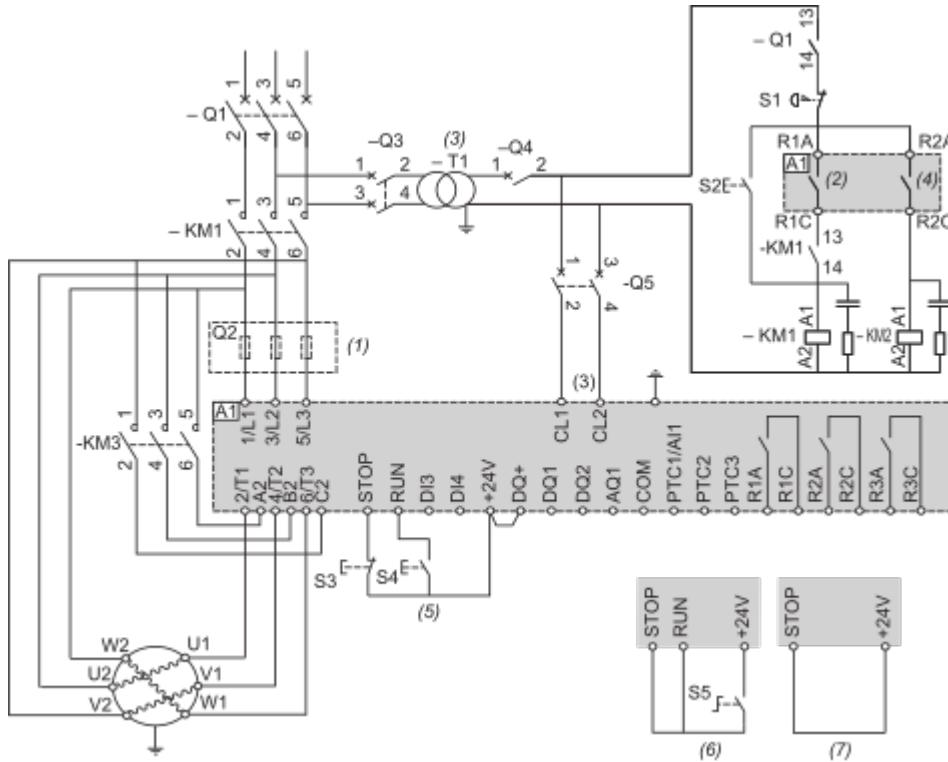
(1) : Installation de fusibles à action rapide supplémentaires pour passer à la coordination de type 2 conformément à la norme IEC 60947-4-2.
