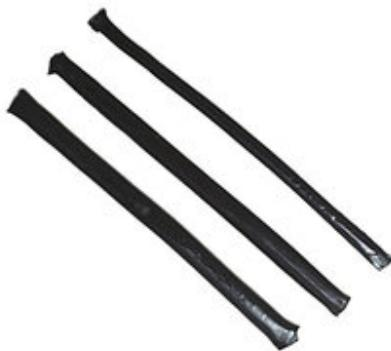
Le JUNTODAN E est un produit pour les joints de dilatation, composées de bitume modifié sous la forme de cordons d'environ 50 cm de longueur et de diamètres différents. Il permet de constituer un joint de dilatation étanche et libre de mouvement dans le temps.
