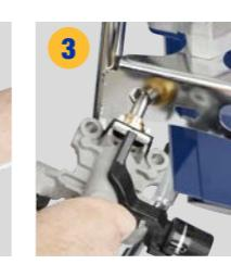
Utilisez un raccord hexagonal à châssis pour desserrer la pompe et retirez la cartouche
