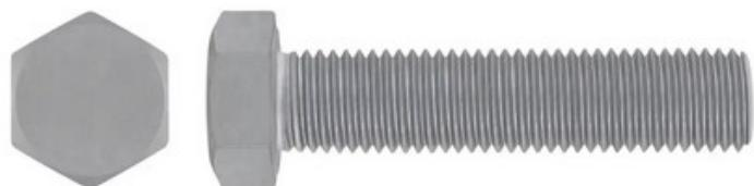
Vis à tête hexagonale filetage total ISO en finition galvanisée à chaud et qualité 8.8
