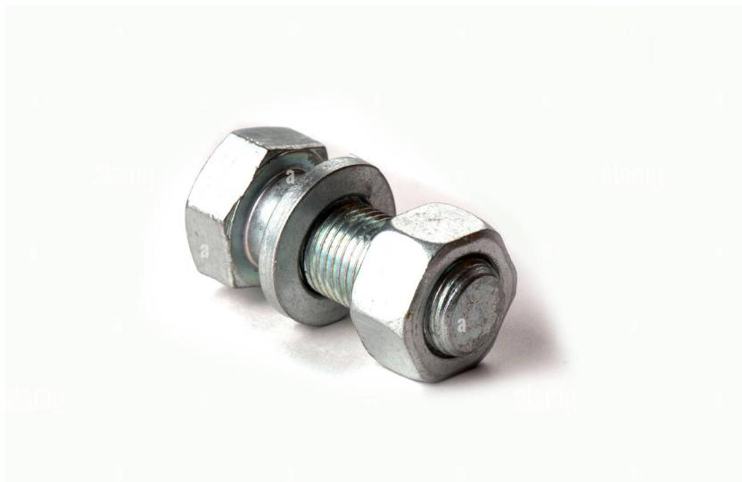
Il s'agit d'un jeu de fixations structurelles pour joints non précontraints avec marquage CE. Il se compose d'un boulon hexagonal à filetage complet ISO 4017 et d'un écrou ISO 4032, tous deux fabriqués en qualité 8.8 et zingués. Il est utilisé dans les structures métalliques tendues en cisaillement dans le secteur de la construction.
