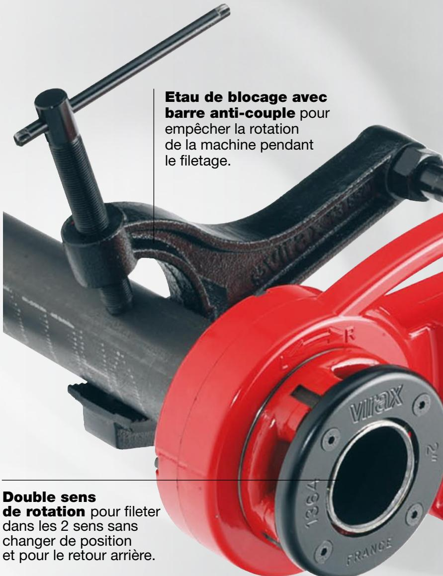
**Double sens de rotation** pour fileter dans les 2 sens sans changer de position et pour le retour arrière.
