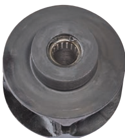
Noix de chaîne de charge avec roulement à aiguilles
