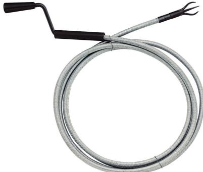
Modèle simple et économique pour usages courants en sanitaire. Cable en fil d'acier galvanisé à chaud, enroulé à spires jointives : très grande flexibilité permettant d'épouser les courbes à rayon court (inférieur à trois fois le diamètre de l'outil). Manche pour faciliter la rotation.
