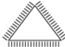
Lime conique triangulaire à double denture sur toutes les faces. Utilisée pour limer les angles, les coins et les rainures.
