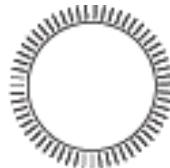
Lime ronde à double spire. Utilisée pour limer les trous et les entailles rondes.
