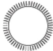
Lime ronde à double spire. Utilisée pour limer les trous et les entailles rondes.
