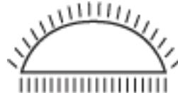
Râpe demi-ronde, conique, avec une coupe râpée des deux côtés. Utilisée pour râper les sections courbes
