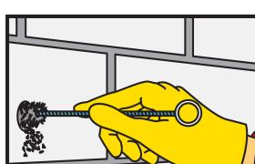
Effectuer le brossage à l'aide d'une brosse spéciale adaptée au diamètre du trou pour éliminer les particules de poussière ; le diamètre de la brosse doit être plus grand que le diamètre du trou.
