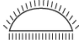
Lime demi-ronde, conique, à double denture des deux côtés. Utilisée pour limer les pièces courbes et les grands trous.
