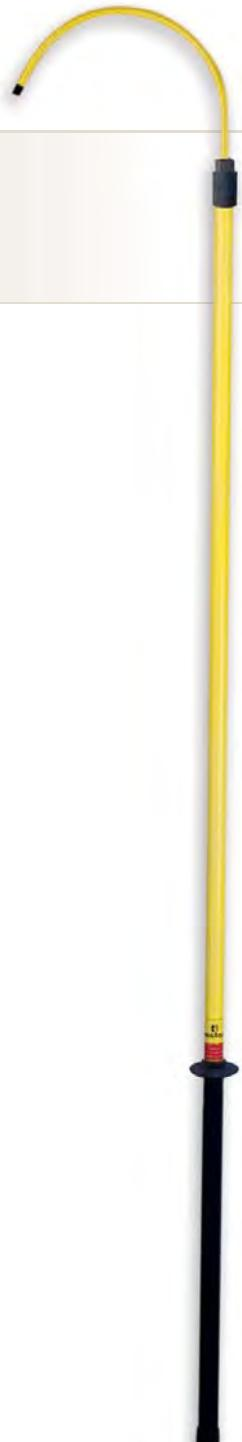
Perche de sauvetage en un élément, fabriquée en tube de polyester et fibre de verre de Ø 32 mm, dotée d'obturations antihumidité aux deux extrémités, garde, poignée, embout, tête métrique M-10 et crochet de sauvetage.
