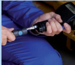
→ **Décompression et déconnexion de vos systèmes et outils pneumatiques en un seul geste :** permet un changement d'outil rapide sur les chaînes d'assemblage et un confort d'utilisation.
