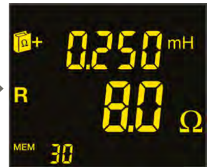
Ecran 3 : valeur de la partie résistive et inductive de l'impédance mesurée
