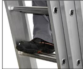
Les montants isolants protègent l'utilisateur des courants de basse et moyenne tension. Isolation testée à 30 000 volts entre 2 barreaux. Conforme à la norme 61478 Cat1.
