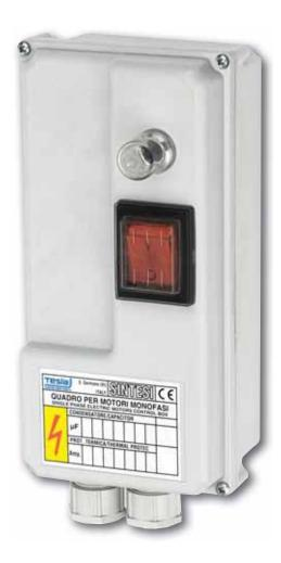
Protection et commande monophasée du moteur/de la pompe pour un démarrage direct. Bo îtier en matériau thermoplastique résistant aux chocs et auto-extinguible avec deux prises antipullaires. Interrupteur principal avec voyant de fonctionnement. Alimentation monophasée 230 V +/- 5 %. Puissances de 1,5 HP. Degré de protection IP44. Condensateur de démarrage. Thermique protection avec réinitialisation manuelle externe.
