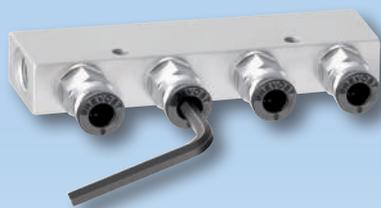
Un profil 6 pans à l'intérieur des raccords droits permet de les implanter par vissage depuis l'intérieur avec une clé 6 pans. Ce système offre l'avantage de faciliter les intégrations de raccords dans les implantations difficiles d'accès.
