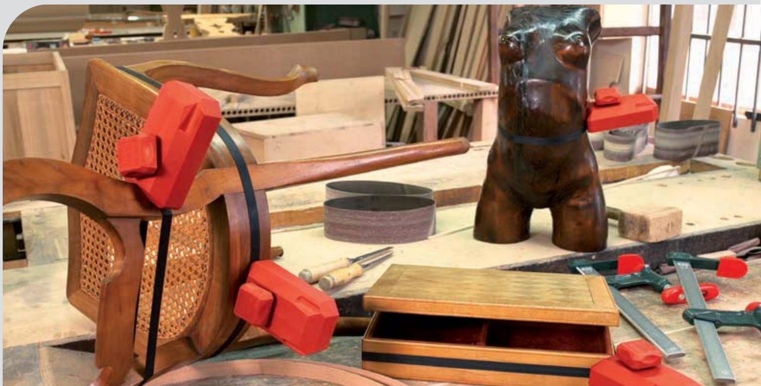
La presse à ruban PR65 est une presse universelle qui serre toutes les formes et ménage les pièces à travailler. Avec son ruban de 6 500 mm, elle permet les emprises les plus importantes. Le serrage se fait de façon équilibrée et puissante. Les 2 brins du ruban-sangle sont tirés en même temps lors du serrage. Ceci évite aux pièces serrées de glisser ou de se déplacer.
