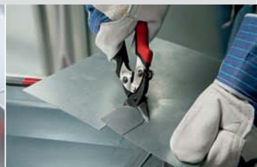
La force démultipliée d'un levier. Avec des tranchants traités par induction et cémentation, les cisailles à démultiplication sont des outils performants et sûrs.
