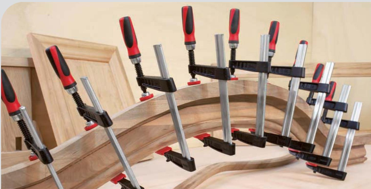
Classiques et irremplaçables. Souvent copiées, jamais égalées, les presses à vis en fonte et acier BESSEY sont des outils de serrage aux qualités uniques. Rails étirés à froid et profilés, mâchoires de serrage renforcées.
