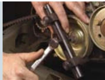
**Extracteur multi-diamètres de poulie de Damper****DM.50**
