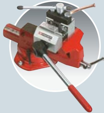
La presse à main DF.475 permet de refaire les collets VL directement sur le véhicule, sans démontage de la totalité du tube.
