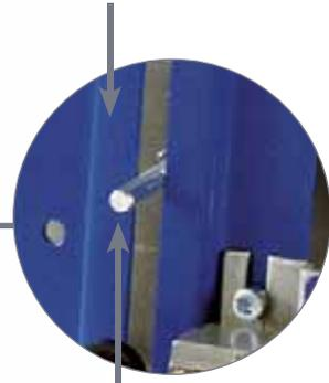
Index centré permettant le montage du boîtier fin de course avec un encombrement réduit
