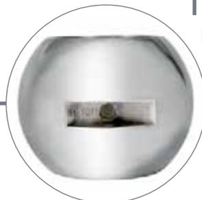
**Trou d'équilibrage des pressions pour éviter le blocage de la sphère en position ouverte**
