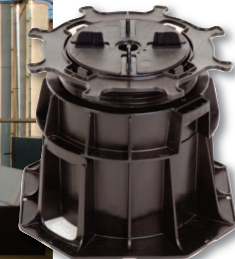
Le Plot Zoom 2 version 100-140 mm de hauteur avec réhausse de 40 mm.
