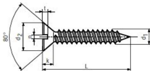
Werkstoff: **Stahl** Einsatzgehärtet 450 HV
