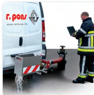
Le véhicule est stationné à proximité du poteau à contrôler. Aucune autre mise en œuvre n'est nécessaire que le raccordement du tuyau à la sortie du poteau.
