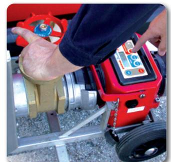
Après ouverture de la vanne du poteau, les différentes mesures peuvent être effectuées en toute sécurité pour l'opérateur et son environnement. Quelque soit sa puissance, le jet d'eau est canalisé au travers du dispositif brise-jet du support **CADYPONS**, il est évacué verticalement vers le sol sans danger.
