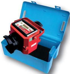
La version **DIGIT** permet le mesurage simultané des débits (en M<sup>3</sup>/heure ou en litres/minute) et des pressions (en bars), des réseaux d'incendie. La fonction totalisation permet d'enregistrer la quantité d'eau consommée.
