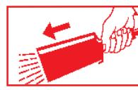
3- Contrôler le débit en manoeuvrant le levier du tromblon
