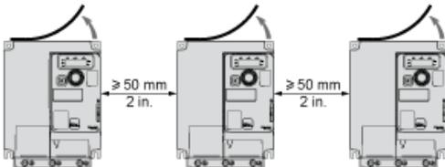
Pour un fonctionnement à température ambiante supérieure à 50 °C (122 °F)
