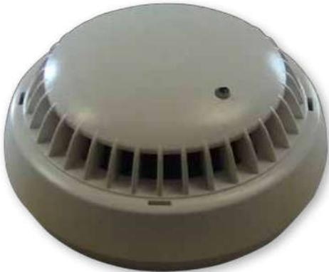
Particulièrement appropriés aux foyers couvants générant des fumées froides et visibles avec forte granulométrie de 0,3 à 2µm par analyse de l'atmosphère par réflexion d'une lumière IR sur les particules de fumée suivant l'effet TYNDALL.
