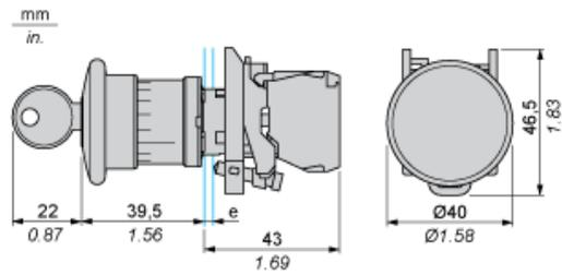
e : épaisseur du dispositif de serrage : 1 à 6 mm / 0,04 à 0,24 pouce
