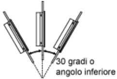
Lorsque le panneau est installé dans une position ayant une inclinaison dépassant 30°, la température ambiante ne doit pas dépasser 40 °C (104 °F). Vous pouvez utiliser un dispositif de refroidissement de l'air (ventilateur, climatiseur) pour vous assurer que la température de fonctionnement ne dépasse pas 40 °C (104 °F).
