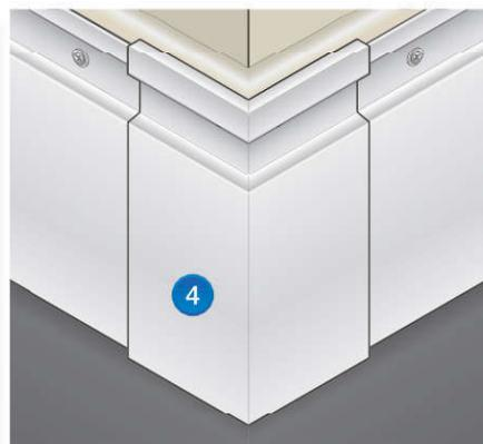
4) **Fourreaux d'angles**, suppriment les coupes d'onglet, économisent les fixations et permettent une finition soignée et étanche.
