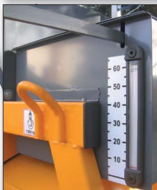
Réservoir d'eau capacité 60 litres avec indicateur de niveau et levier de commande. Raccord d'eau pour remplissage situé de l'autre côté du tableau de commande.
