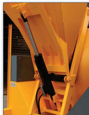
Vérin double effet avec clapet de sécurité bloquant le chargeur en toute position même dans le cas de rupture du circuit hydraulique.
